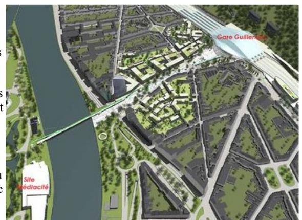
**L'impressionnant ouvrage d'art**, d'une largeur de 5,5 mètres pour une longueur totale de 294 mètres, a été posé entre les deux rives de la
