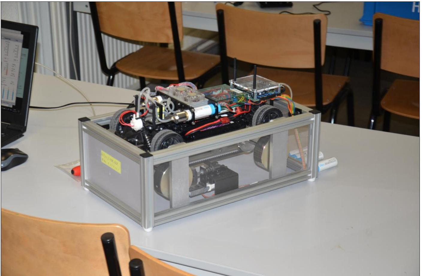
Visite des infrastructures et équipements du centre de compétence « Technifutur - Campus automobile » - Prototype de voiture fonctionnant à partir d'un réservoir à hydrogène.
